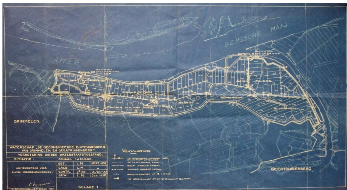
Afbeelding 25: Blauwdruk voor de verbetering van de afwatering in de Gecombineerde Buitenpolders voor de Emiliapolder, 1937-1938 (AWBD, Emiliapolder, 457).
