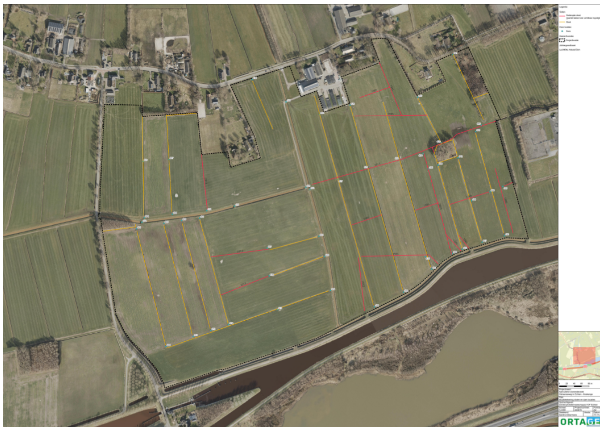
Figuur 4.5d: Situatietekening met locaties sloten, gedempte sloten en dammen
