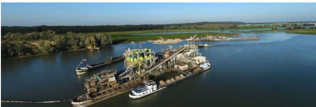
Foto 2 Voorbeeld natte grondstofwinning middels drijvende zandklasseerinstallatie
