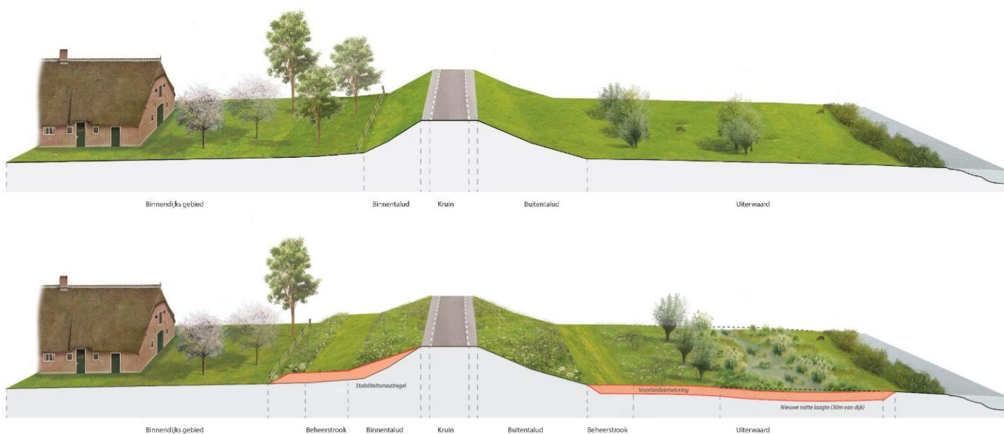
Figuur 0-1 Indicatief principeprofiel van kansrijk alternatief “Natuurlijk versterkt”. Het bovenste profiel toont de huidige situatie. (zie voor een grotere weergave pagina 22)
