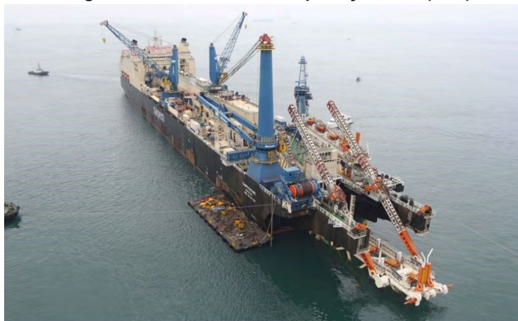
Afbeelding 2.3 Voorbeeld van een Pipe Lay Vessel (PLV):
