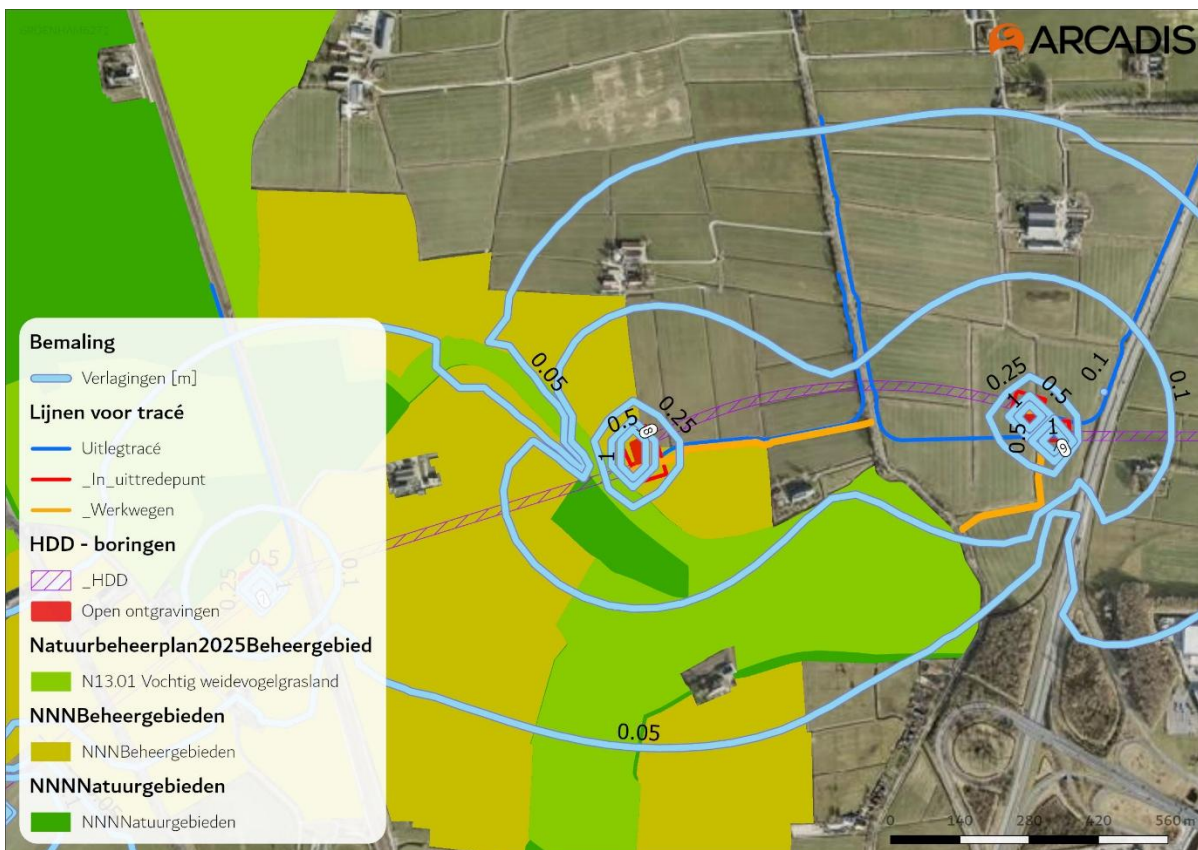
Figuur 21. Bemalingsverlagingen bij boorlocatie 8 en 9 (Arcadis, 2025b).
