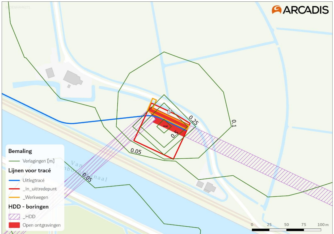
Figuur 17. Grondwaterstandverlagings als gevolg van bemaling bij boorlocatie 5. De getallen geven de verlaging in meters aan.
