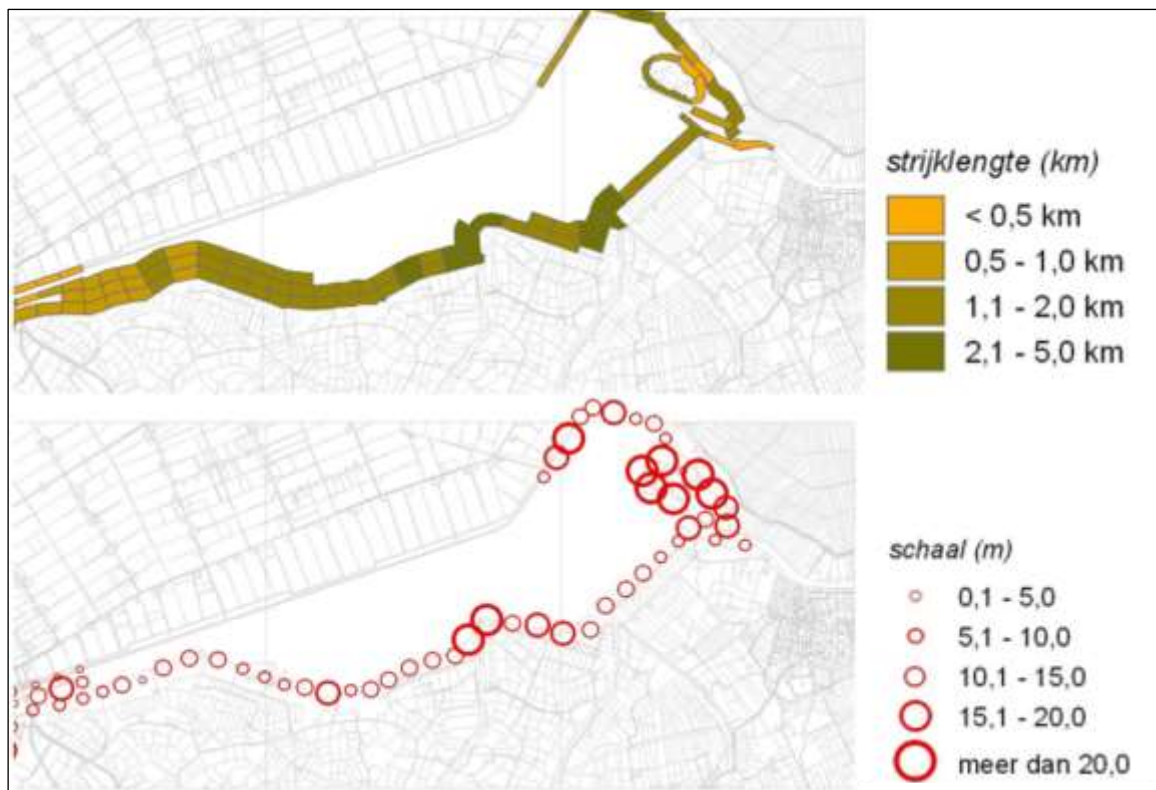
Afbeelding 4.17 De strijklengte als maat voor windwerking op rietoevers en de breedte van waterrietzones in het Zwarte Meer in 2007 (bron: van der Hut et al., 2008). De schaal van de rietoevers betreft de maximale diameter van de in water staande rietvegetaties; dit is een maat voor de breedte van de waterrietvegetatie
