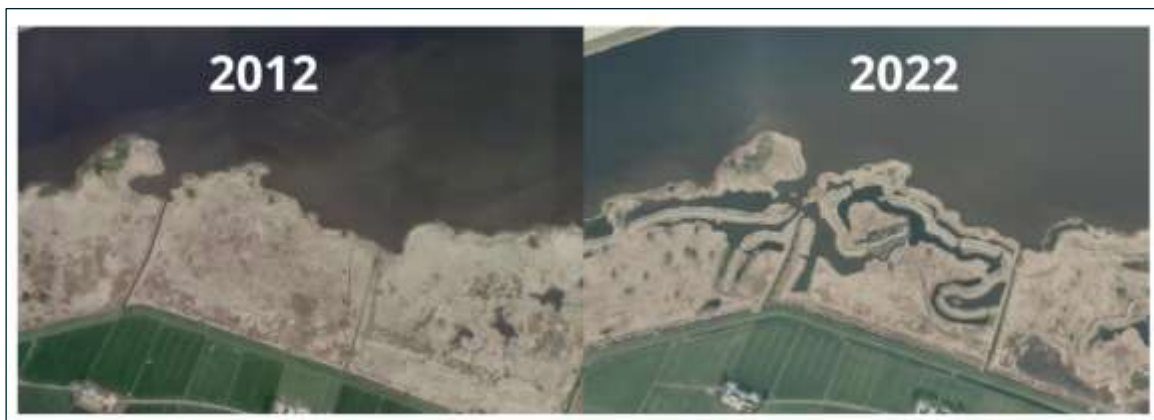
Afbeelding 4.19 Situatie in het centraal zuidelijke deel van de oeverzones langs het Zwarte Meer in 2012 en 2022 (ter hoogte van het vogelringstation), waar in de tussentijdse jaren herinrichting heeft plaatsgevonden en ook rasters zijn geplaatst tegen begrazing door watervogels (bron: Jurriens & Vreugdenhil, 2023)
