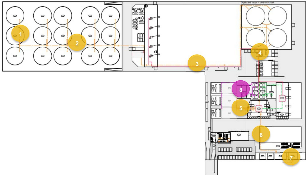
Figuur 4 Schematische weergave leidingloop. De belangrijkste leidingen zijn de biogas-leidingen (oranje) en Bio-LNG leidingen (roze).
