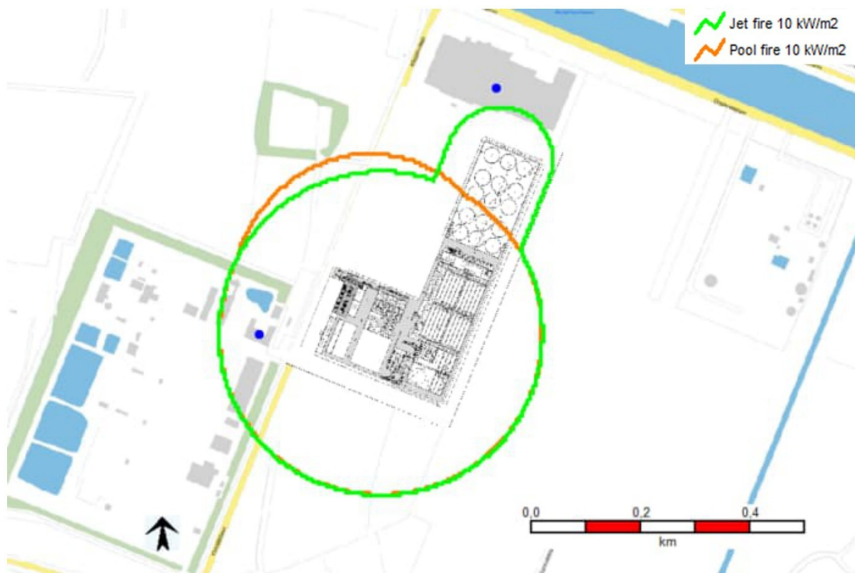
Figuur 7: Brandaandachtsgebied (in oranje de 10 kW/m 2 van de pool fire en groen van de 10 kW/m 2 jet fire scenario's)
