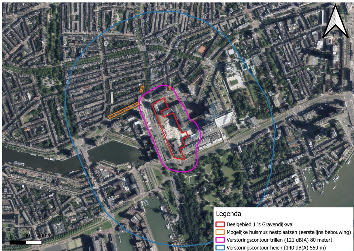
Afbeelding 4.8 Verstoringsscontouren funderingswerkzaamheden en mogelijke huismusverblijfplaatsen
