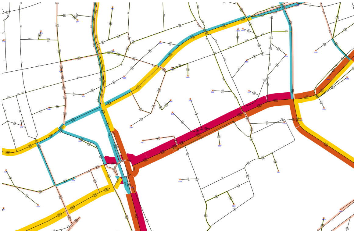
Afbeelding 3.14 Etmaalintensiteiten uit het V-MRDH 3.0 voor de referentiesituatie (2040=2050) met VCP (Haskoning, 2025)
