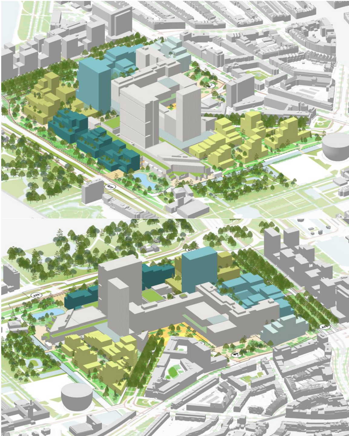
Afbeelding 4.4 Perspectief op het resultaat van een hogere bouwmassa (conform masterplan: 720k m 2 ) qua microklimaatoptimalisatie - Variant D (oriëntatie; boven: zuidoost, onder: noordoost)
