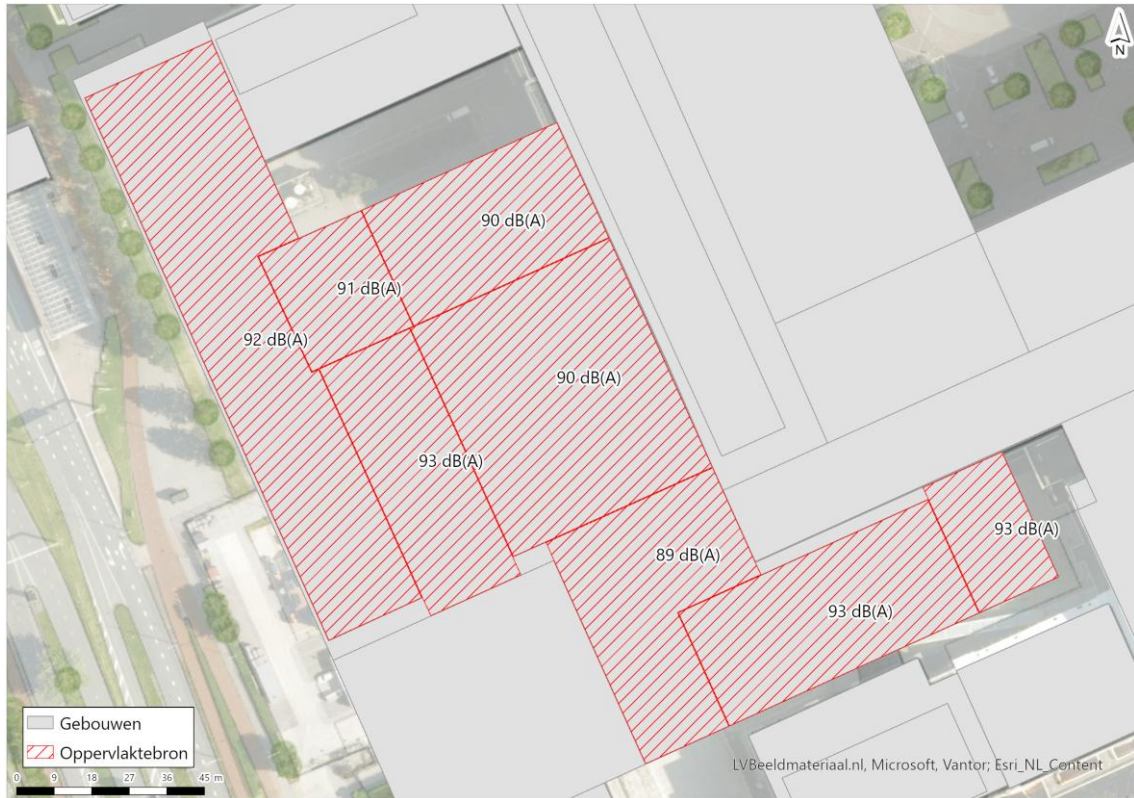
Afbeelding 3.7 Geluidbudget in dB(A) voor de installaties op de SPOT-locatie
