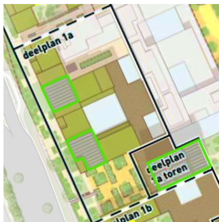
Afbeelding 5.1 Oppervlakte beschikbare daken voor zonnepanelen
