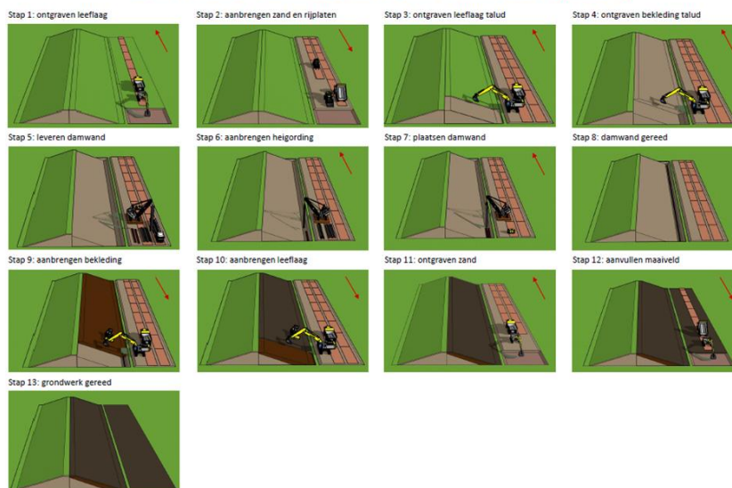
figuur 3-2: Overzichtsfiguur grondwerk standaardwerkmethode (Bron Dijkversterking Zwolle-Olst, WDODelta)
