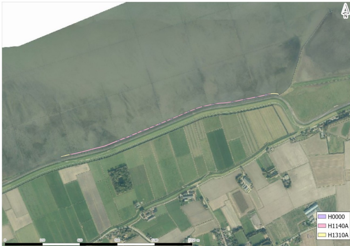
Afbeelding 4.4 Een uitvergroting van het tijdelijke ruimtebeslag van de dijkverbetering op habitattypen, tussen kilometer 43,0 en 46,0. Het betreft ruimtebeslag op H0000 geen habitatype, H1140A slik- en zandplaten (getijdengebied) en H1310A zilte pionierbegroeiingen (zeekraal)
