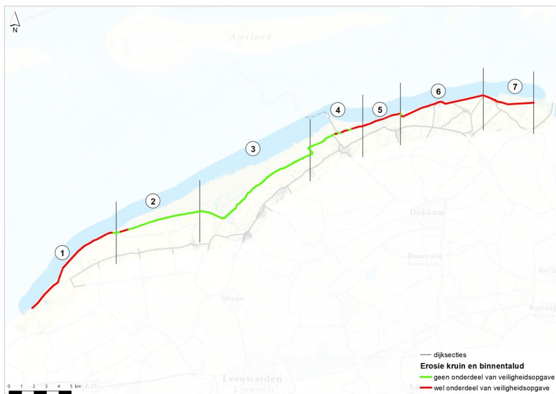
Afbeelding 2.9 Erosie kruin en binnentalud
