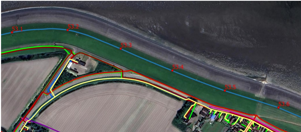
Afbeelding II.7 Middenspanningskabel (rood) van Liander, datakabel (groen) van KPN in toekomstig te realiseren voetpad bij Peazens-Moddergat
