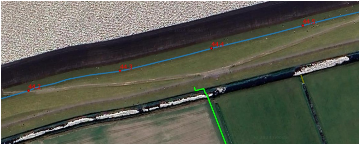
Afbeelding II.1 datakabel KPN in het toekomstig binnenberm en te verflauwen sloottalud in Polder
