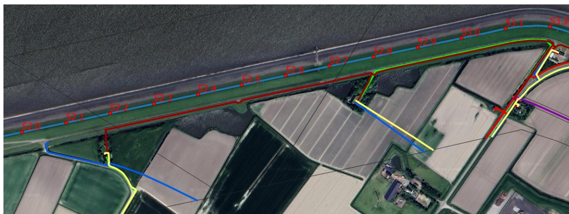
Afbeelding II.5 Laagspanningskabel (bruin) van Liander, waterleiding (blauw) van Vitens en datakabel (groen) van KPN toekomstig te realiseren binnenberm bij Wierum oost
