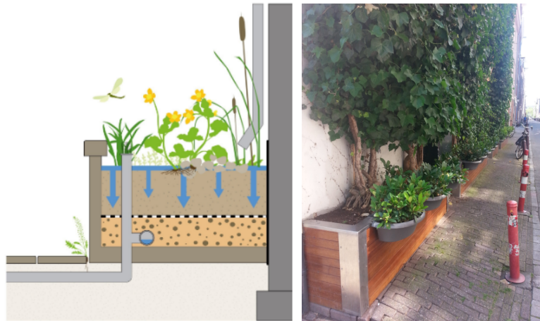
Figuur 5-7 Schematische doorsnede van een watervasthoudende plantenbakken (© Atelier Groenblauw)
