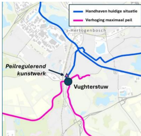
Figuur 0-2 Weergave van de locatie van het peilregulerend kunstwerk en scheiding tussen het Dommelsysteem en Aa-systeem. Bron: Waterschap de Dommel & Waterschap Aa & Maas, 2025a.
