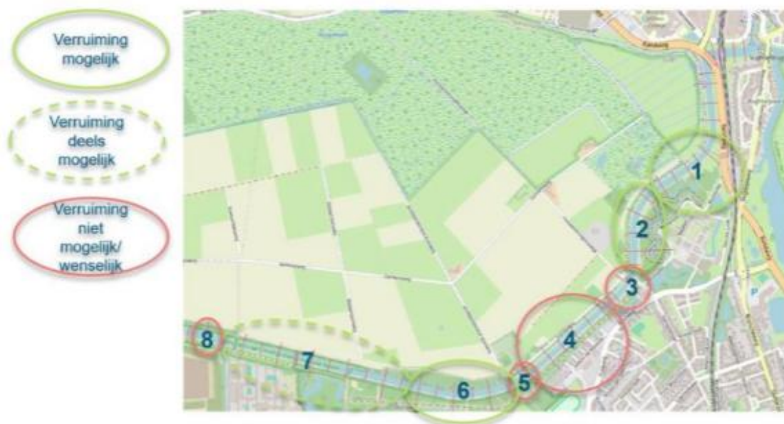
Figuur 0-16 Vergroten Drongelens Kanaal: Locaties om oevers af te graven, alleen binnen de groene cirkels (niet gestippeld) is nu het plan om af te graven. Bron: Waterschap Aa & Maas, 2025f.
