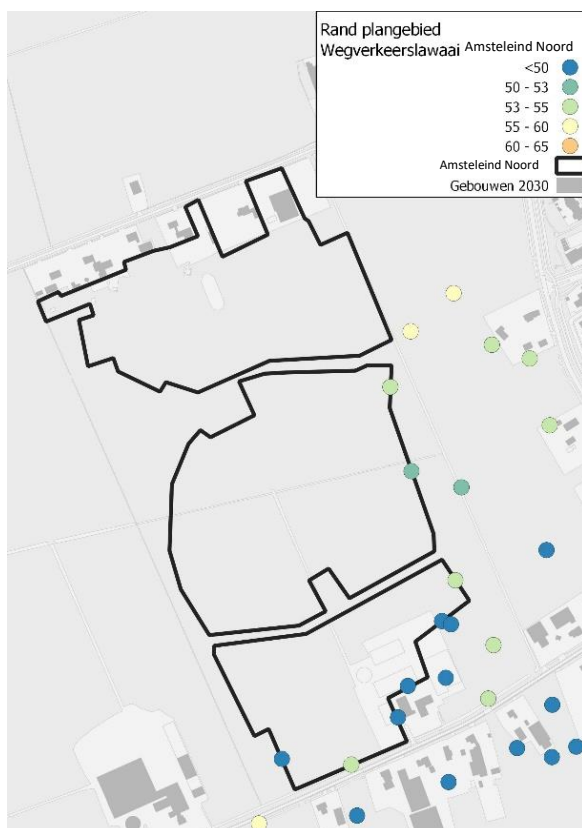
Afbeelding 6.3 Hoogst berekende geluidbelasting vanwege wegverkeerslawaai op de rand van ontwikkelvlakken (Lden)
