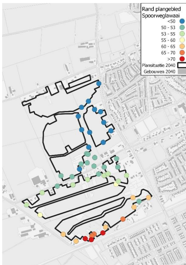
Afbeelding 5.5 Hoogst berekende geluidbelasting vanwege spoorweglawaai op de rand van ontwikkelvlakken (Lden)
