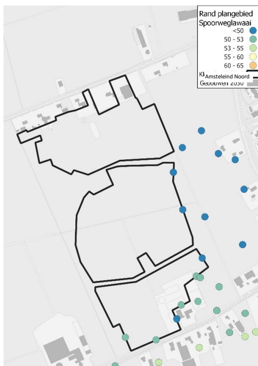
Afbeelding 6.5 Hoogst berekende geluidbelasting vanwege spoorweglawaai op de rand van ontwikkelvlakken (Lden)
