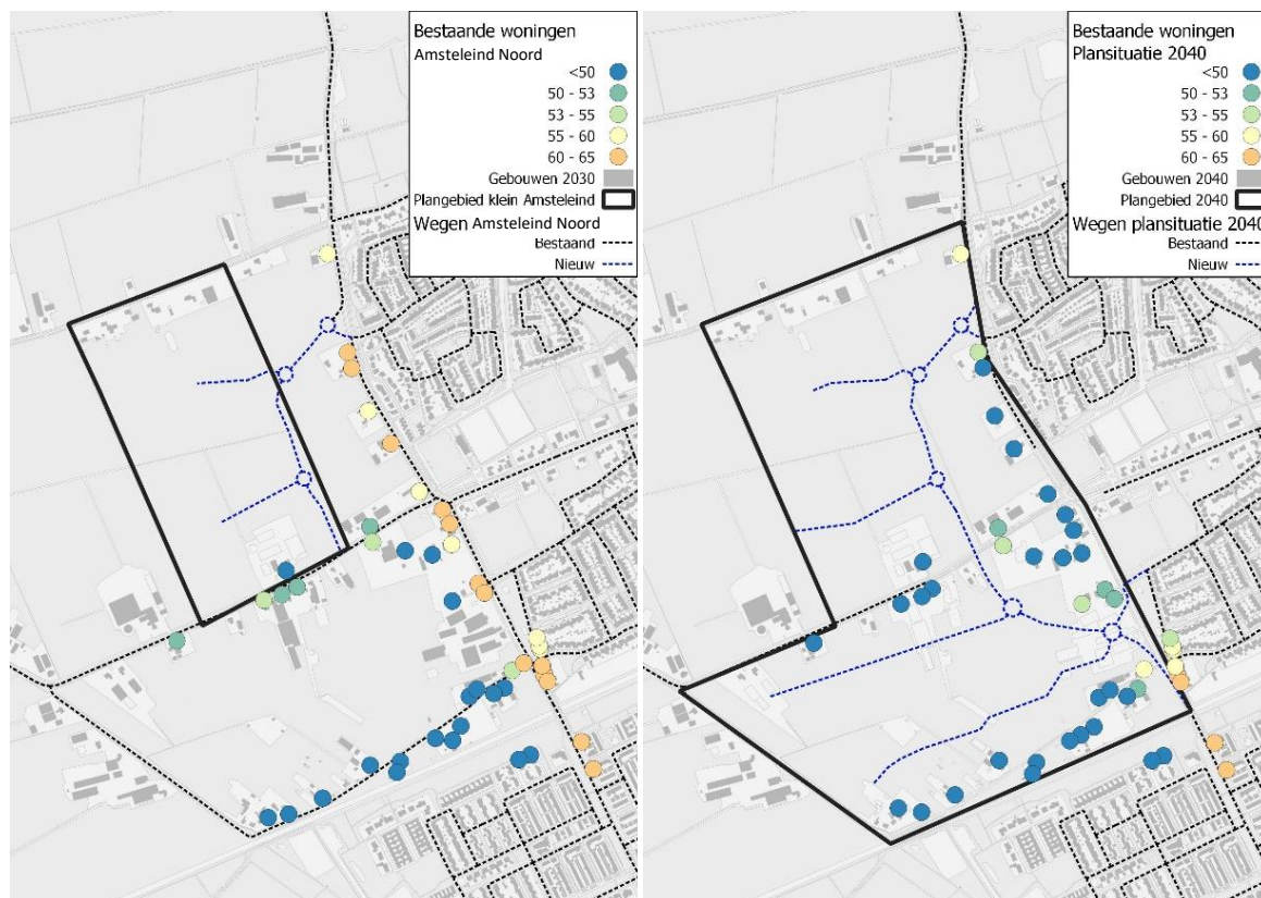
Afbeelding 7.3 Hoogst berekende geluidbelasting vanwege wegverkeerslawaaai op bestaande woningen (Lden)
