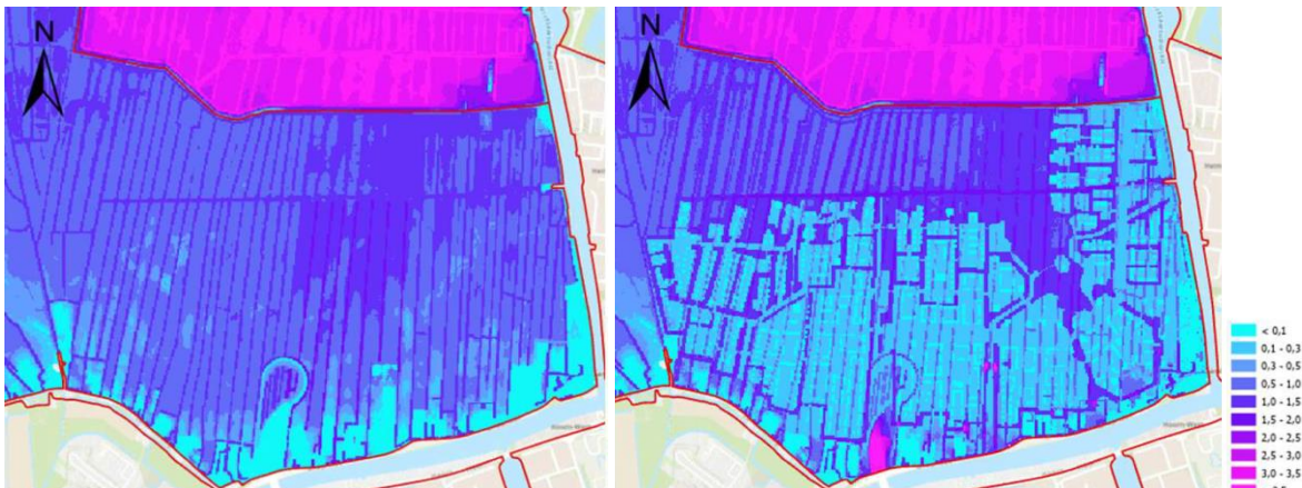
Figuur 5-4 Inundatiedieptes in de huidige situatie (links) toekomstige situatie (rechts) bij een overstroming, gebaseerd op scenario's van de EU-Richtlijn Overstromingsrisico's (ROR) en doorgerekend in Tygron (Hoogheemraadschap van Rijnland, 2025). De maaivelhoogte is gebaseerd op het masterplan en de verwachte maaiveldverhoging uit de GREX
