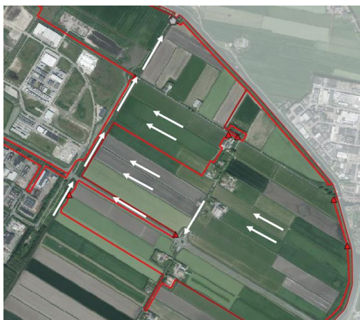
Figuur 4-3: Stroomrichtingen bestaande situatie T100-lang
