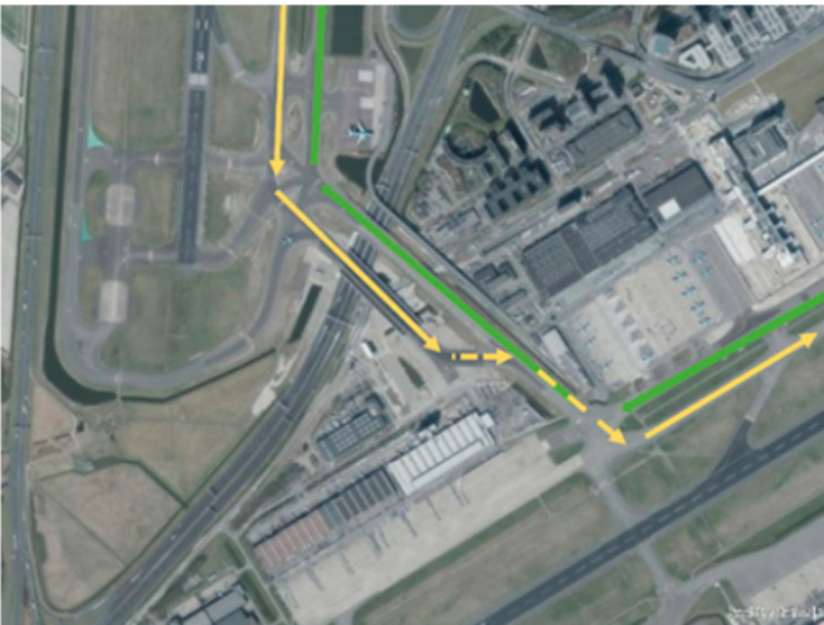
Figuur D.3: Kleiner gebied voor het tweerichtingsverkeer, wat wachttijden voor tegemoetkomend verkeer reduceert [Bron: https://integralsafetyschiphol.com/nl/project/voltooiing-dubbel-rijbaanstelsel/ ]
