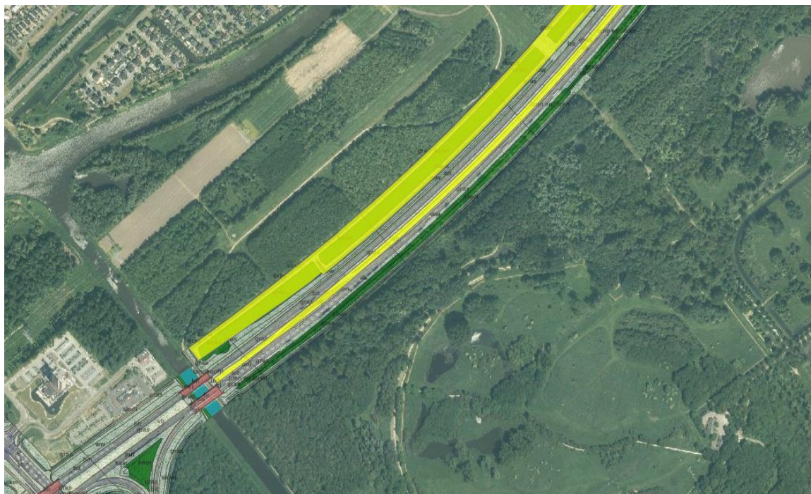
Afbeelding 4.2 Zonnepanelen (geel) in de middenberm en buitenberm van Hoofdrijbaan Links bij de Boog om Lelystad
