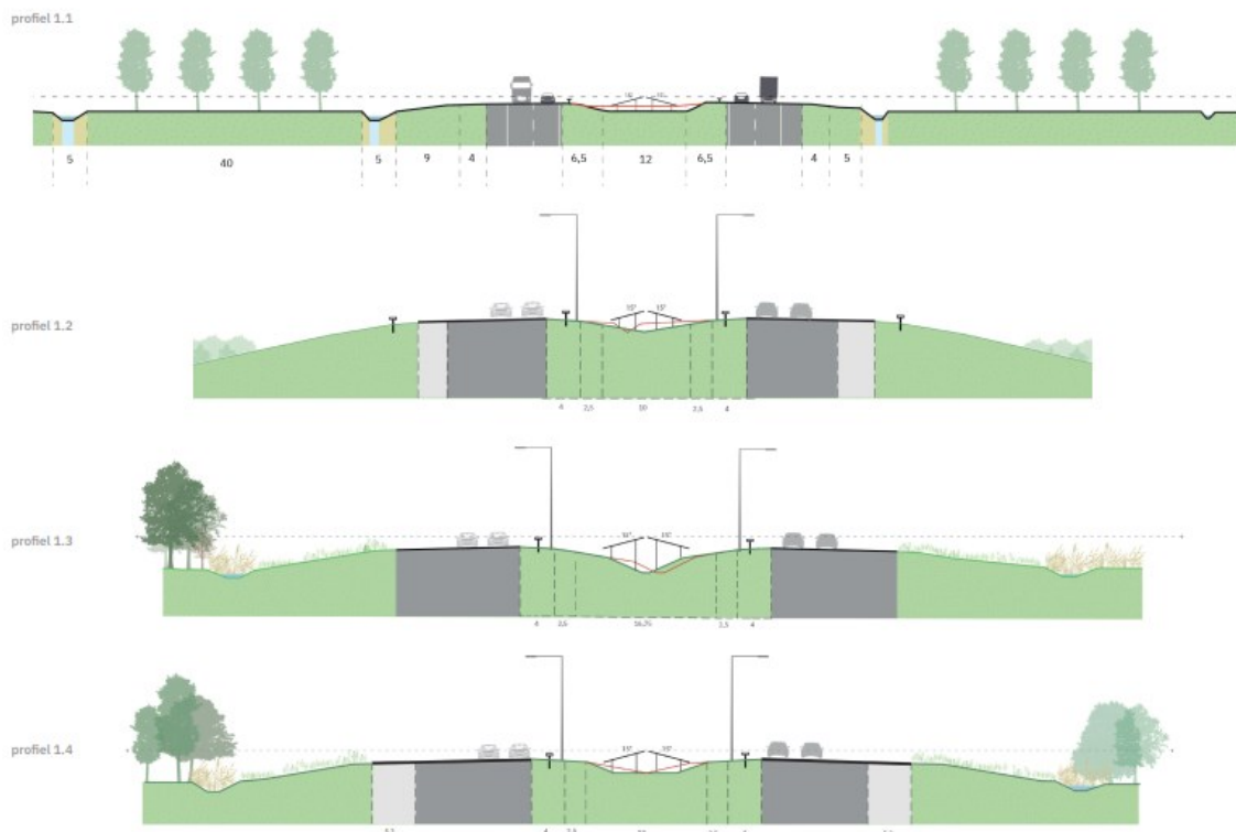
Afbeelding 5.7 Dwarsprofielen middenbermen [ref. 12]
