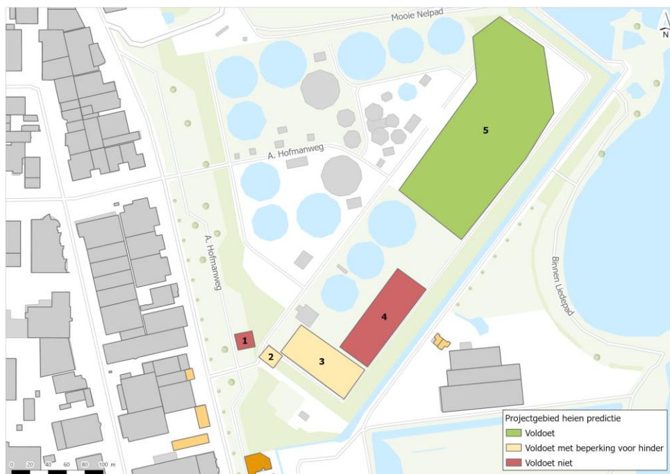
Afbeelding 5.1 Beoordeling van de streefwaarden voor het heien van funderingspalen op de verschillende aanbrengvlakken
