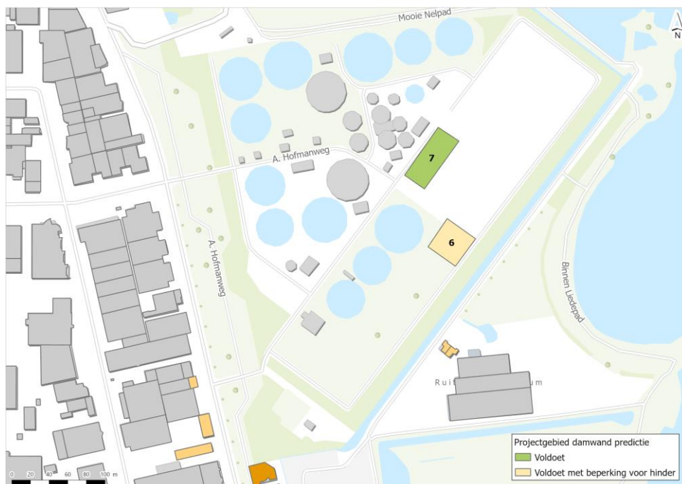
Afbeelding 5.2 Beoordeling van de streefwaarden voor het intrillen van damwanden op de verschillende aanbrengvlakken
