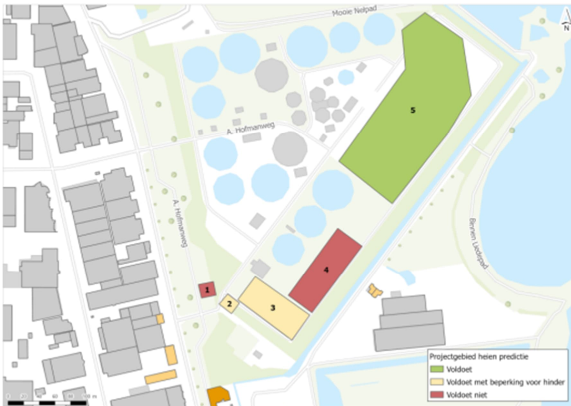
Figuur 7.4: Schematische weergave van de projectlocatie. Binnen de gele, groene en rode vlakken moeten funderingspalen worden aangebracht (Bron: Trillingsanalyse, Wi+Bo 2025).
