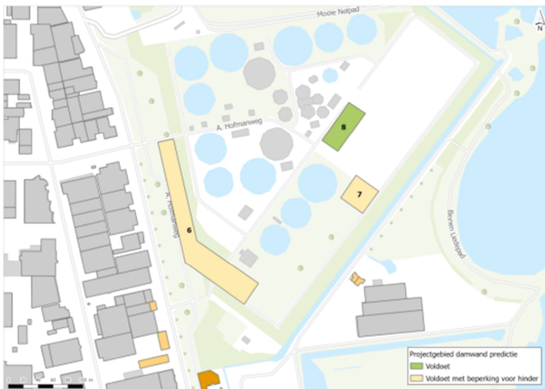
Figuur 7.5: Schematische weergave van de projectlocatie. Binnen de gele en groene vlakken moeten damwanden worden aangebracht (Bron: Trillingsanalyse, Wi+Bo 2025).
