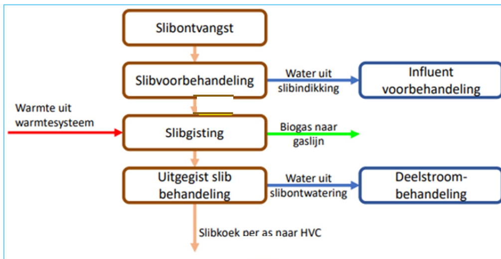
Figuur 3-4: Schematische weergave van de slibvergistingsinstallatie (overgenomen uit Witteveen+Bos rapport 135467/25-003.094).
