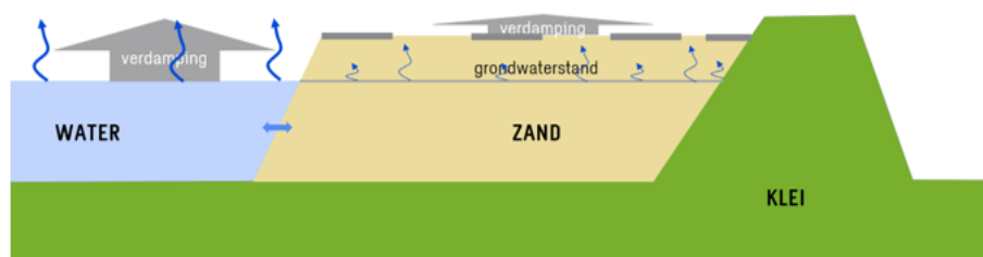
Figuur 17: Schematische weergave van het effect van uitwisseling met grondwater (boven) en het effect van verschil in verdamping (onder) [Sweco, 2024, bewerking door Haskoning, 2026]
