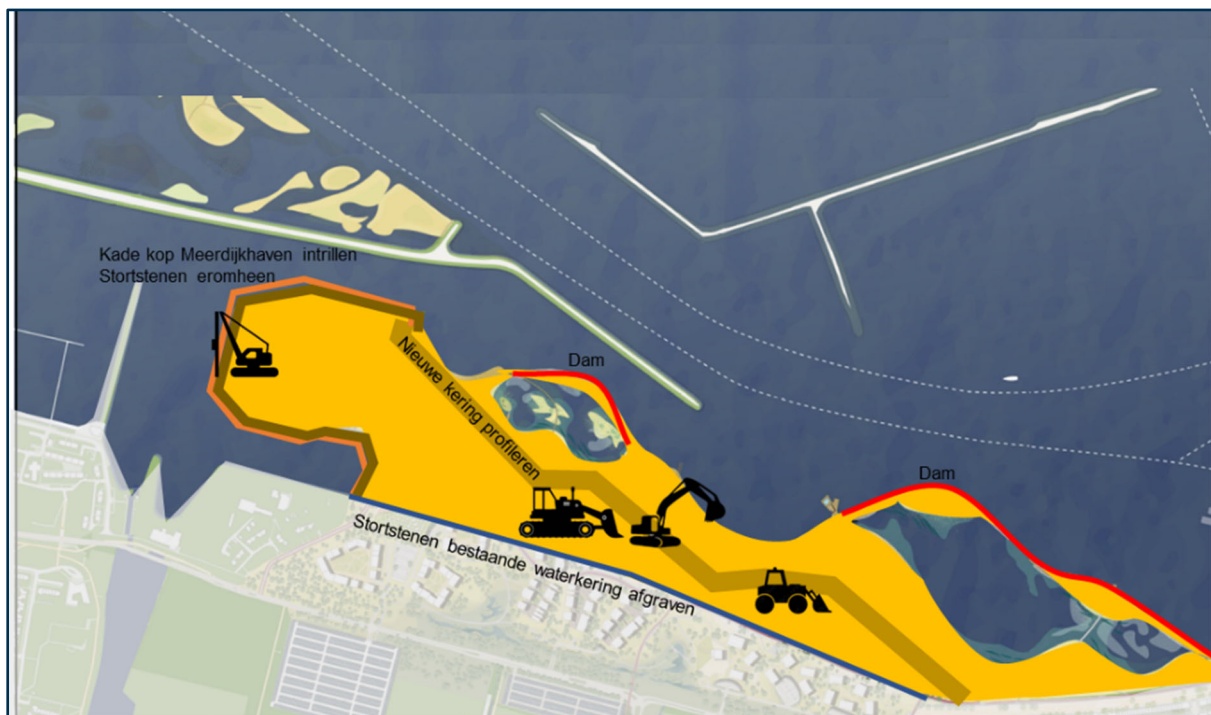
Figuur 13. Activiteiten Landaanwinning Meerdijkhaven
