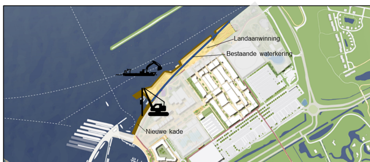
Figuur 14. Aanlegwerkzaamheden voor kadeconstructie en landaanwinning van Bataviakwartier
