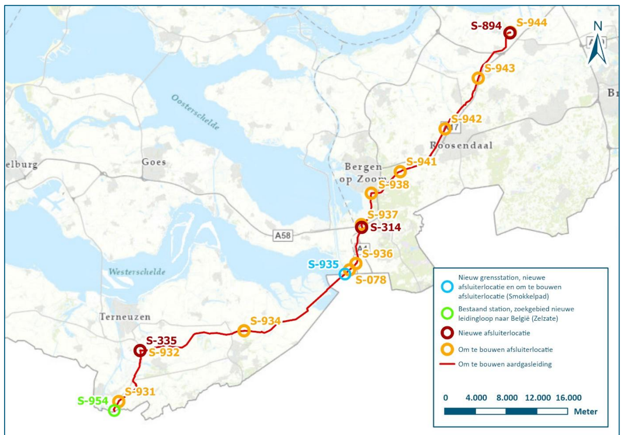
Figuur 15-1. Bestaande tracédeel Zelzate – Moerdijk (A-671).
