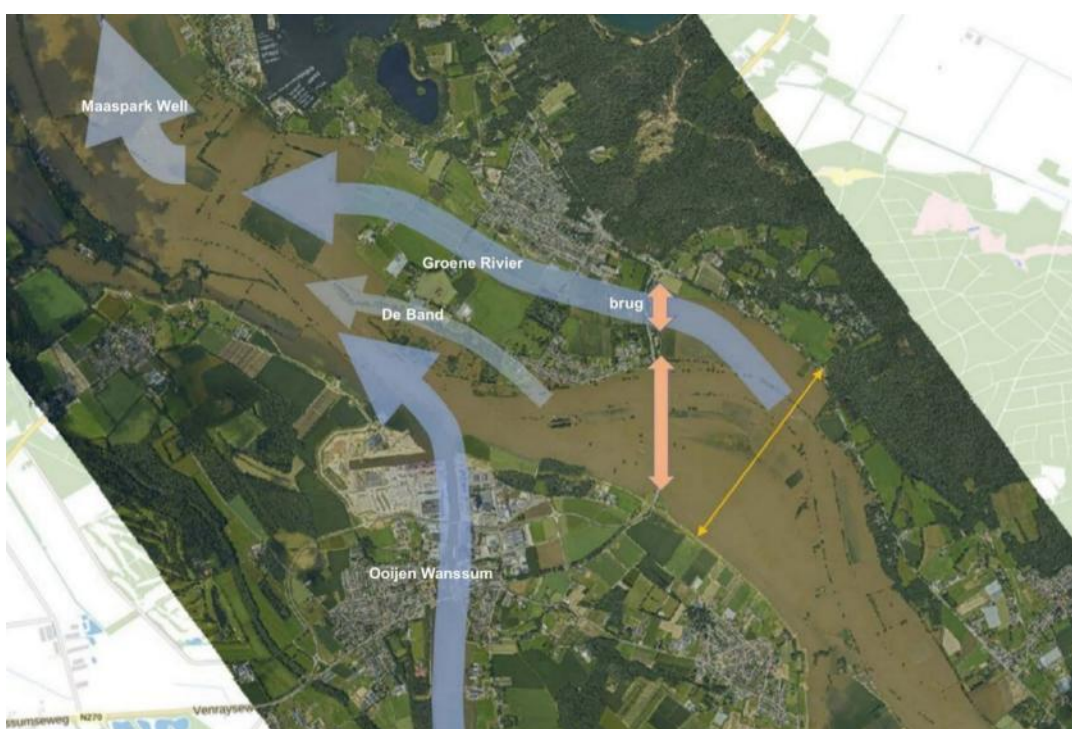
Figuur 4.3: Schematische weergave van de systeemwerkingsmaatregelen ter verbetering van de huidige rivierkundige situatie zoals weergegeven in figuur 3.1; openen van de oude Maasarm door dijkteruglegging, herinrichting, introductie van een brug en verbetering van de doorstroming in de Band.
