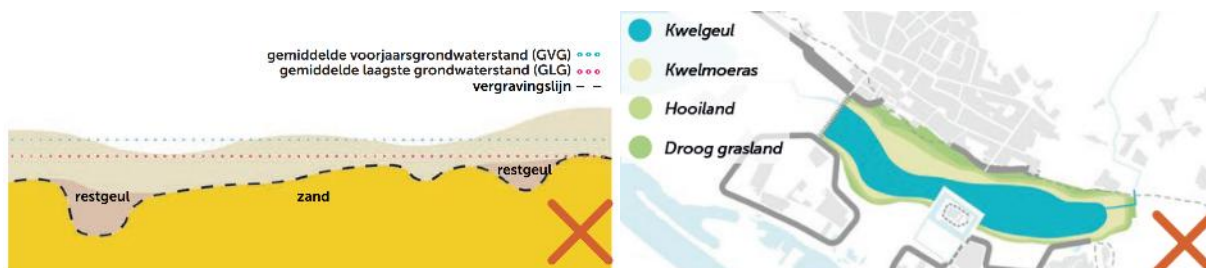
Figuur 4.3 Principe bodemvolgend ontgraven
