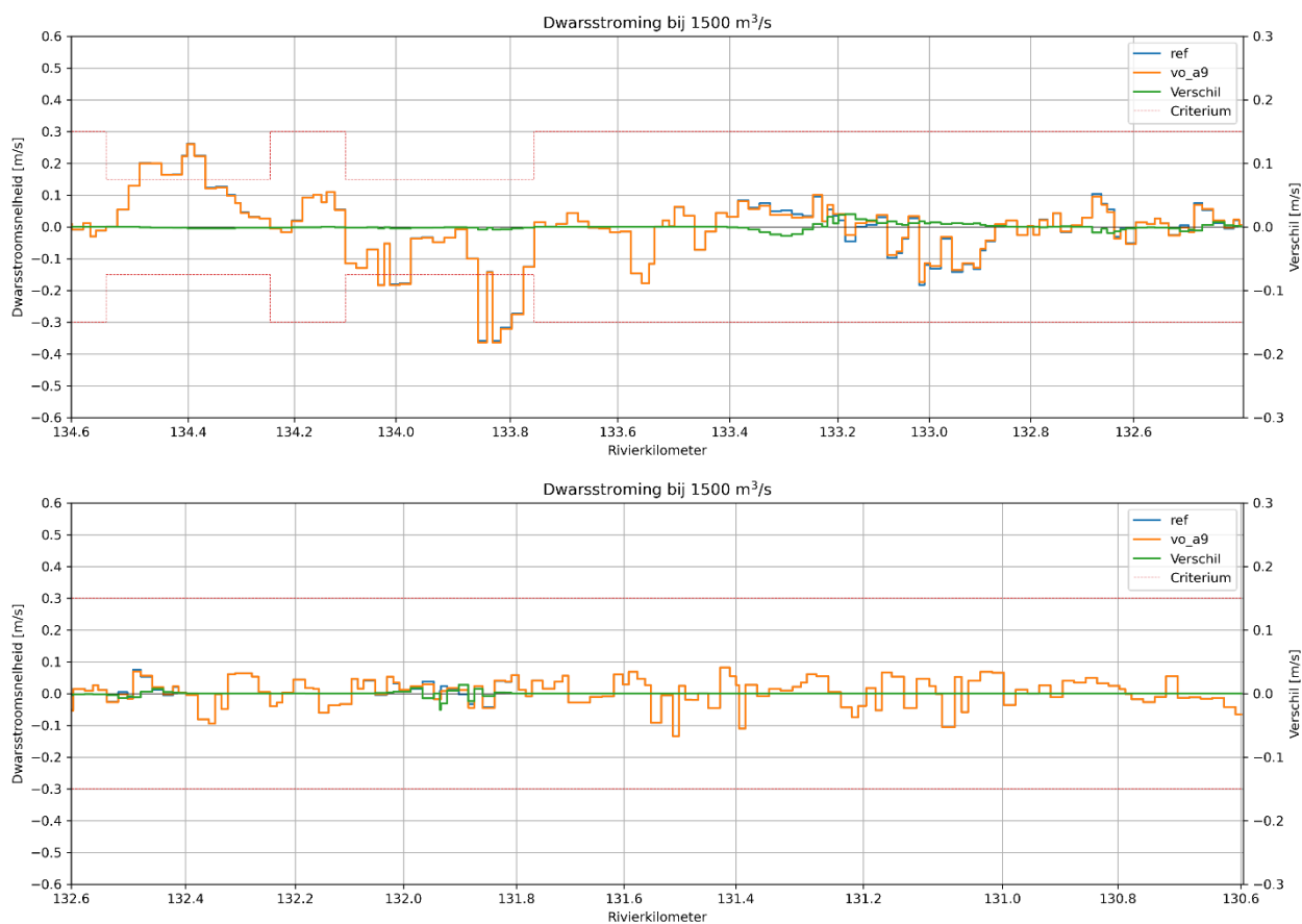
Figuur C-2: Dwarsstroming op de rand van de vaarweg (m/s) bij 1.500 m³/s tussen het ontwerp (in figuur 'vo_a9') en de referentie (in figuur 'ref'). Bovenste figuur toont benedenstroomse deel van traject en onderste figuur toont bovenstroomse deel van traject. Groene verschil-lijn hoort bij rechter as, overige lijnen bij linker as.
