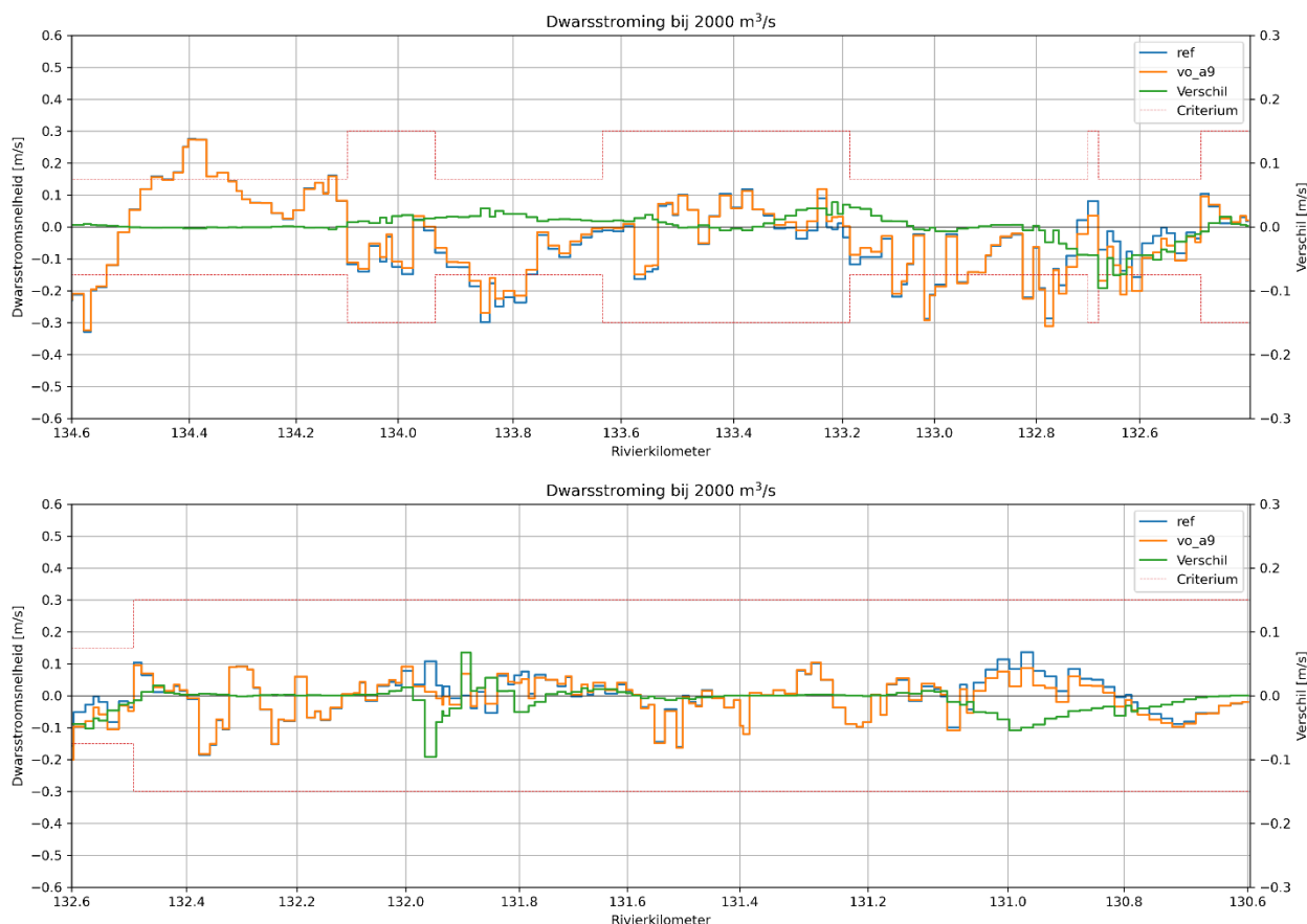
Figuur 15: Dwarsstroming op de rand van de vaarweg (m/s) bij 2.000 m³/s tussen het ontwerp (in figuur 'vo_a9') en de referentie (in figuur 'ref'). Bovenste figuur toont benedenstroomse deel van traject en onderste figuur toont bovenstroomse deel van traject. Groene verschil-lijn hoort bij rechter as, overige lijnen bij linker as.
