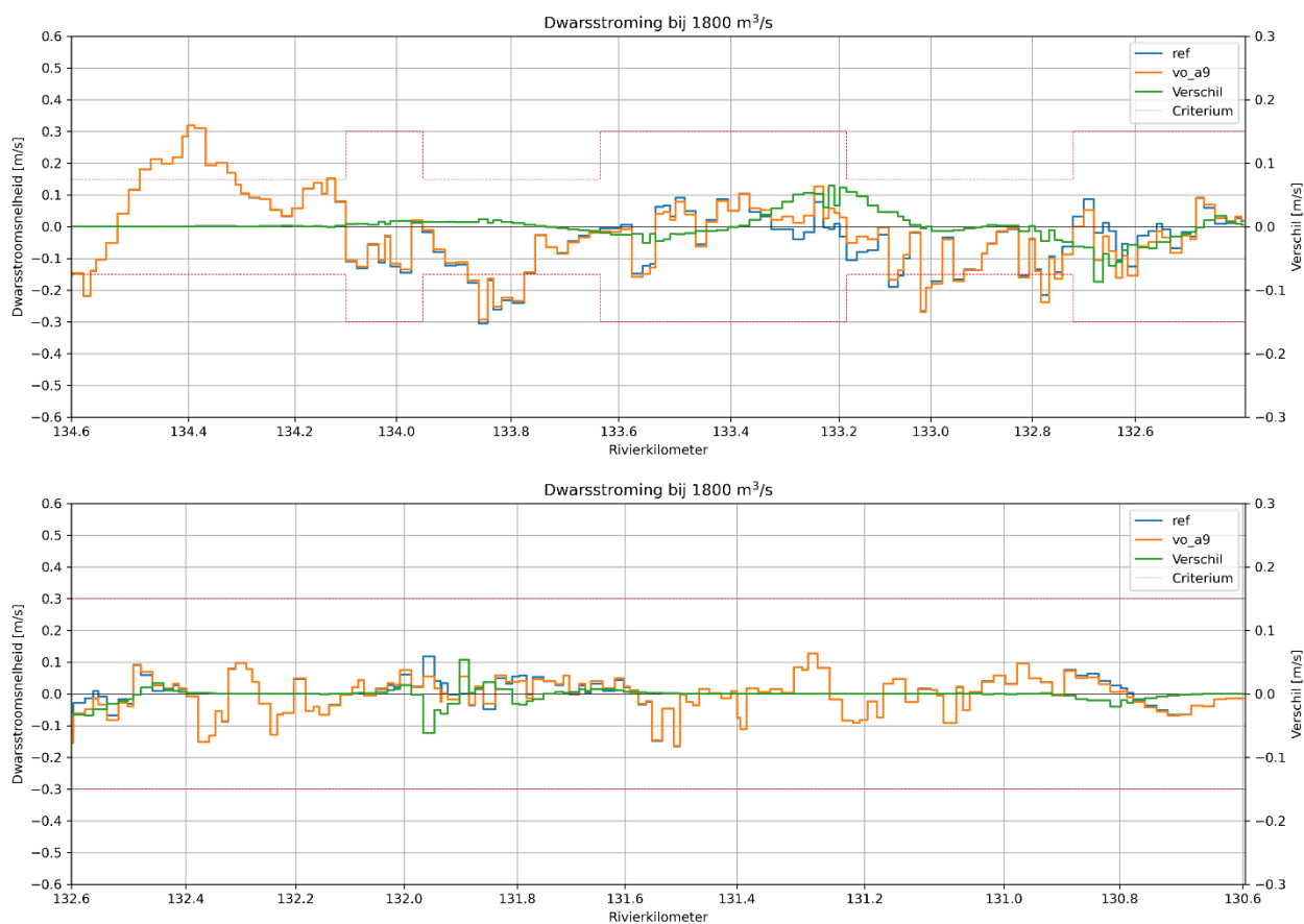
Figuur C-1: Dwarsstrooming op de rand van de vaarweg (m/s) bij 1.800 m³/s tussen het ontwerp (in figuur 'vo_a9') en de referentie (in figuur 'ref'). Bovenste figuur toont benedenstroomse deel van traject en onderste figuur toont bovenstroomse deel van traject. Groene verschil-lijn hoort bij rechter as, overige lijnen bij linker as.
