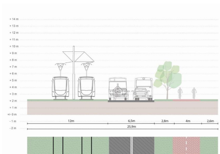
Figuur 10: Dwarsprofiel bestaande situatie Laan van Maarschalkerweerd
