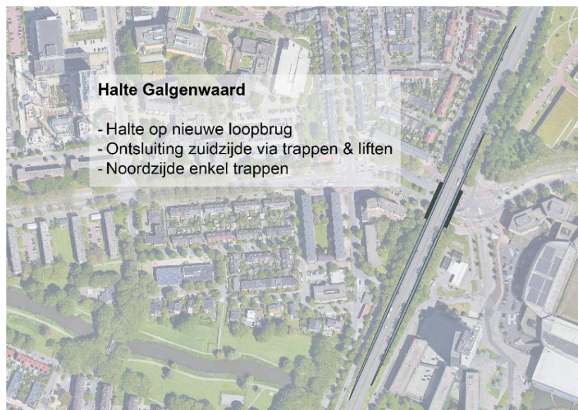
Figuur 2: Bovenaanzicht halte Galgenwaard met uitbreiding kunstwerk t.b.v. extra rijstroken en inpassing van de halte. De bushaltes zijn in zijligging gepositioneerd.
