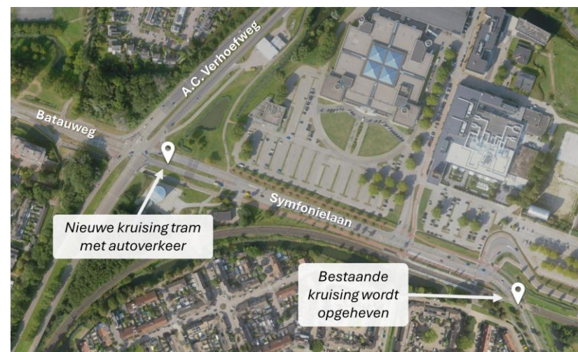
Figuur 39: In alternatief 3 wordt één bestaande kruising (tram met auto en fietsers) opgeheven en wordt één nieuwe kruising (tram met auto en fietsers) gecreëerd.
