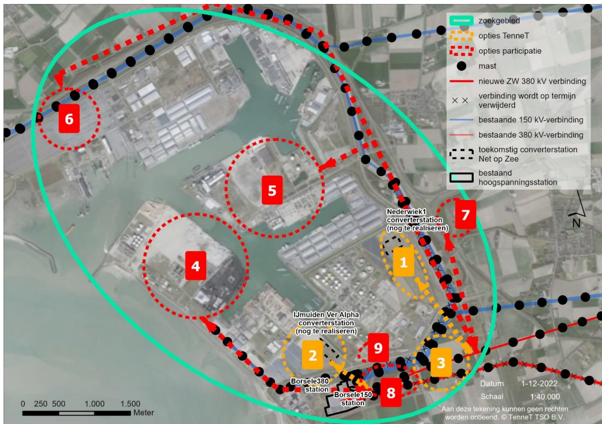
Figuur 2-1 Locatie- en tracéopties 380kV-hoogspanningsstation
