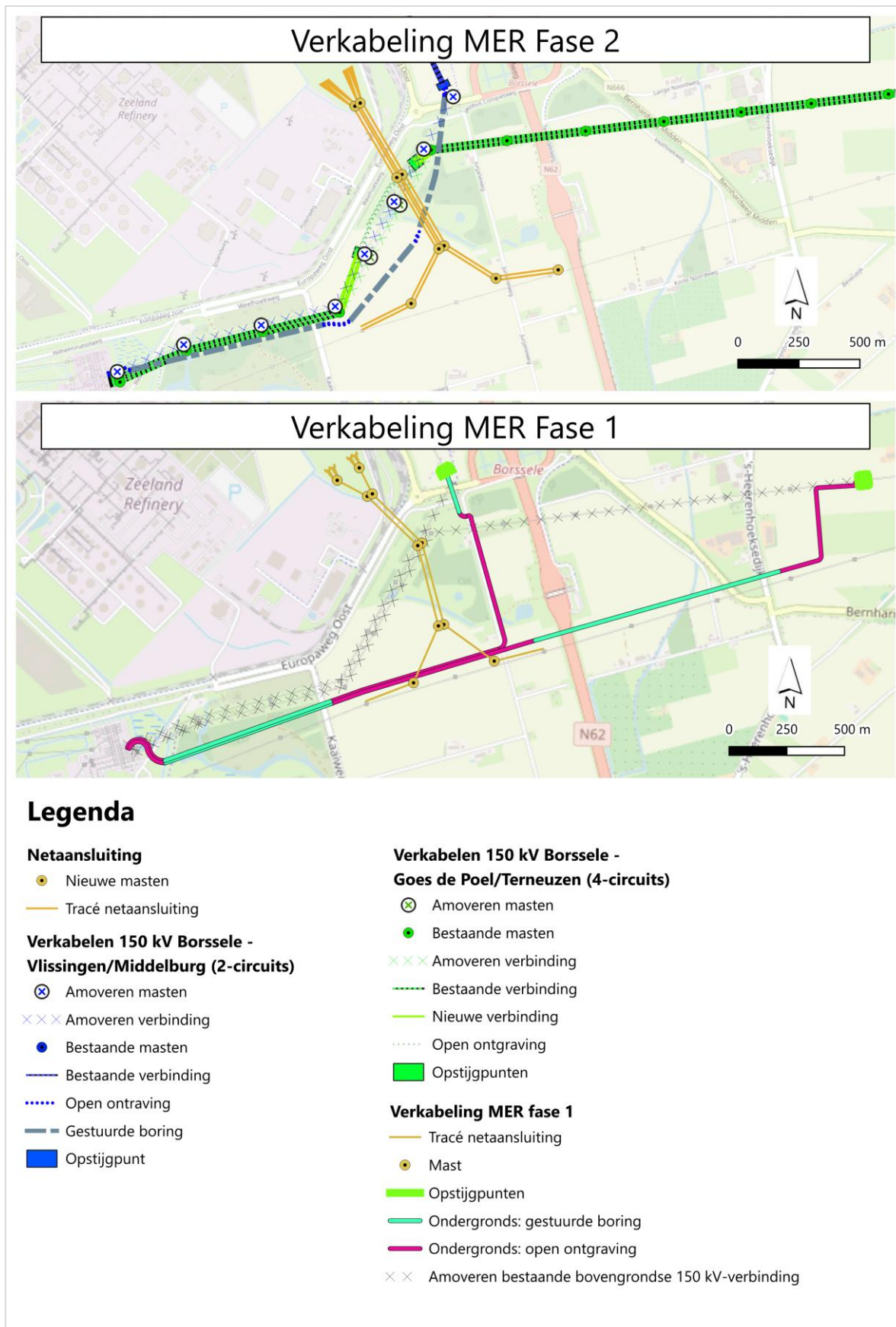
Figuur 3.12 Verschil verkabeling 150kV-verbindingen tussen MER Fase 1/IEA en het VKA
