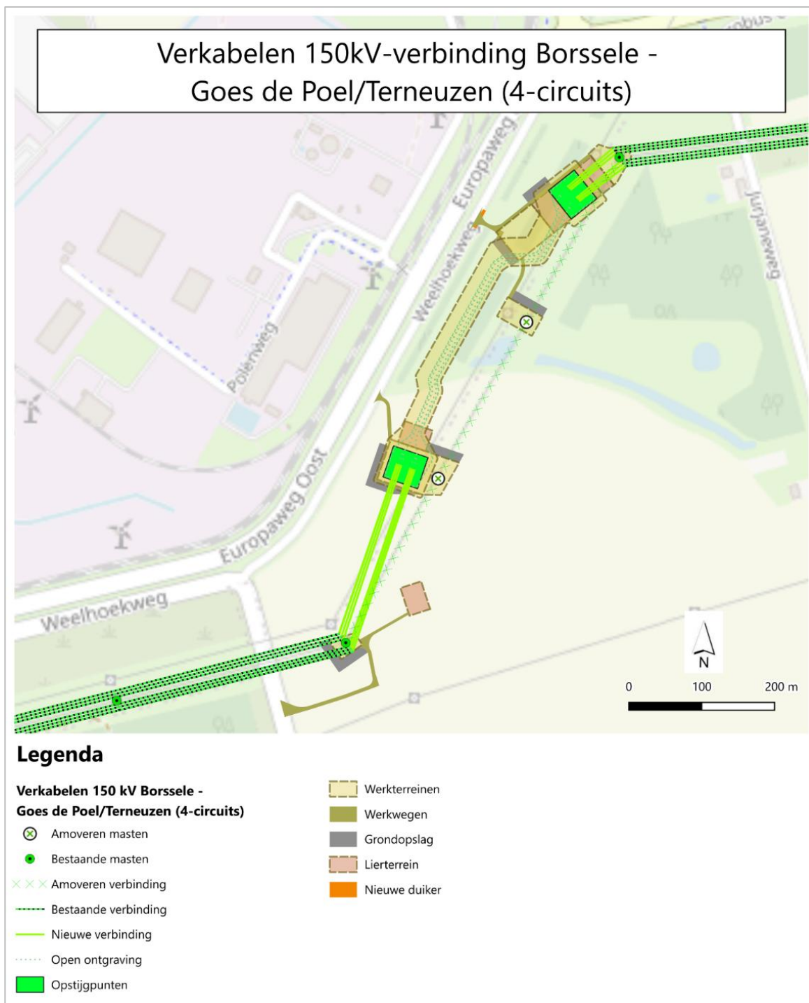
Figuur 3.9 Verkabelen 150kV-verbinding Borssele – Goes de Poel/Terneuzen
