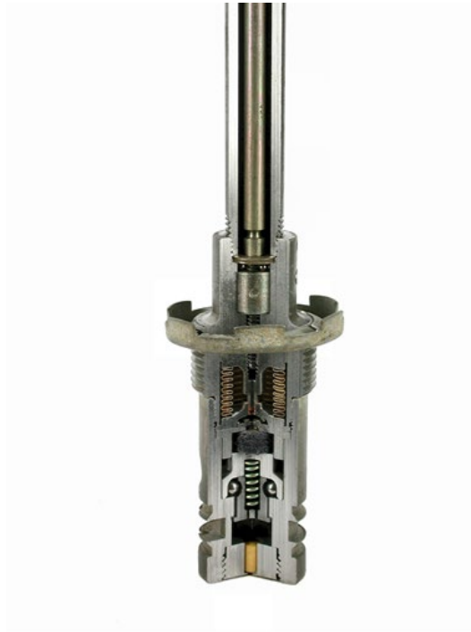
Voorgespannen slagpinveer in bomontsteker.
