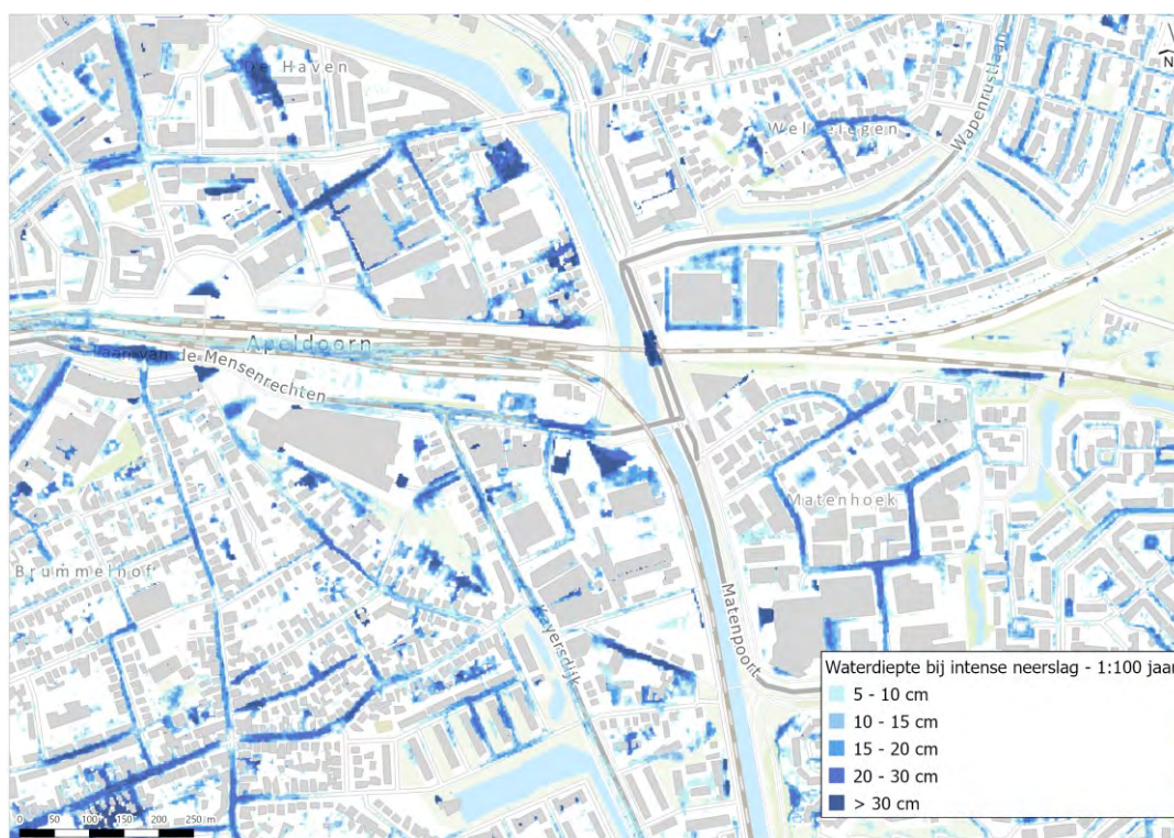
Afbeelding 8.1 Wateroverlast in Spoorzone-Oost bij een bui van 70 mm in 2 uur (1/100 jaar, bron: klimateffectatlas.nl)
