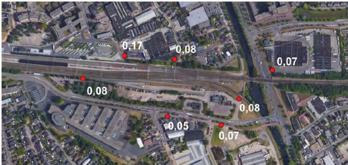
Afbeelding 7.16 Gemiddelde trillingsterkte in de bodem in de referentiesituatie (Peutz, Trillingonderzoek, 1 december 2023)
