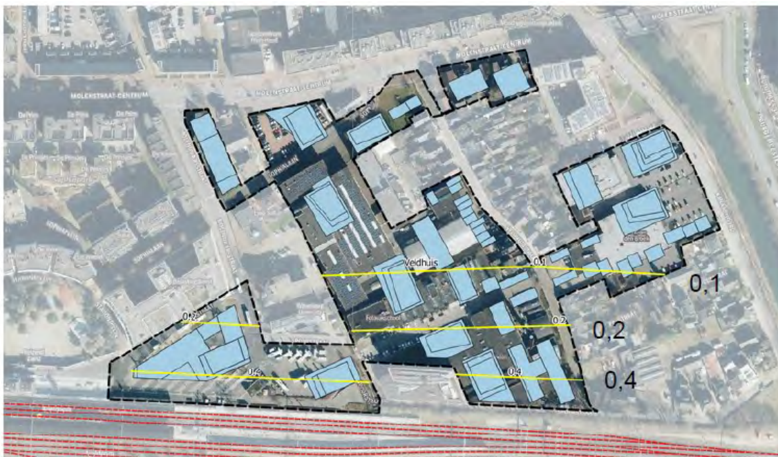
Afbeelding 7.30 Trillingscontouren van de te verwachten maximale trillingsterkte (Peutz, Trillingonderzoek, 1 december 2023)
