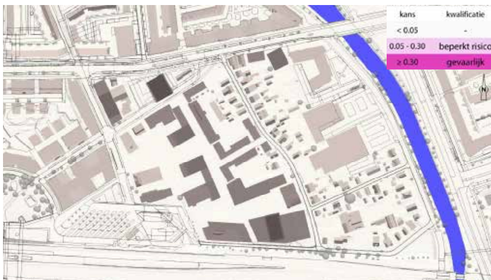
Windgevaar in de geplande bebouwingssituatie
