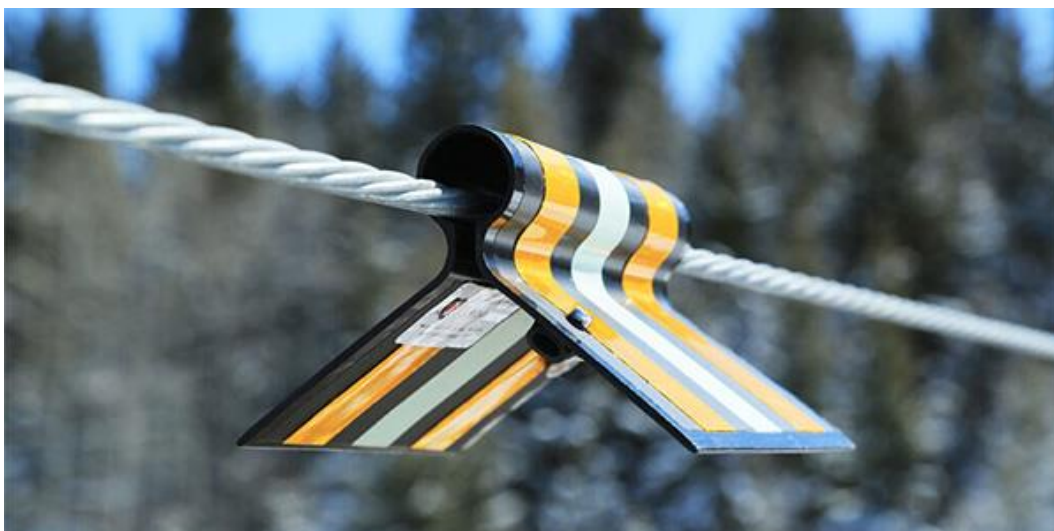
Figuur 6.1 Hawk Eye BFD bestaat uit twee fluorescerende/reflecterende strips (geel) en een 'glow in the dark' strip die de gehele schemer- en donkerperiode zichtbaar is. De A-vorm zorgt ervoor dat de BFD vanuit alle hoeken goed zichtbaar is. Er zijn verschillende maten verkrijgbaar voor verschillende draaddiameters, van 5 mm tot 38 mm diameter (bron: www.powerlinesentry.com ).
