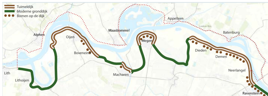
Figuur 18: Hoofdopbouw tuimeldijk, moderne gronddijk en bomen op de dijk bij Dijkversterking Meanderende Maas.
