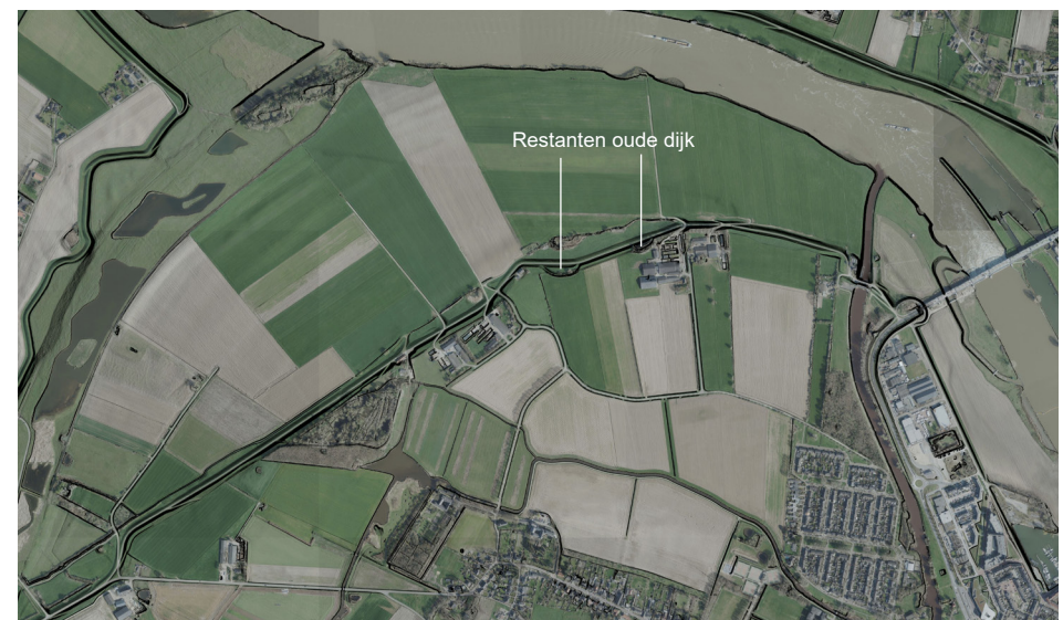
Figuur 15: de huidige rechtgetrokken dijk, met binnendijks twee restanten van de oude dijk.
