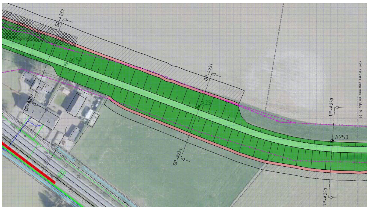
Figuur 6-1 Dijkvak 14 - Overgang van geen buitenwaartse verplaatsing naar een buitenwaartse verplaatsing van de dijk
