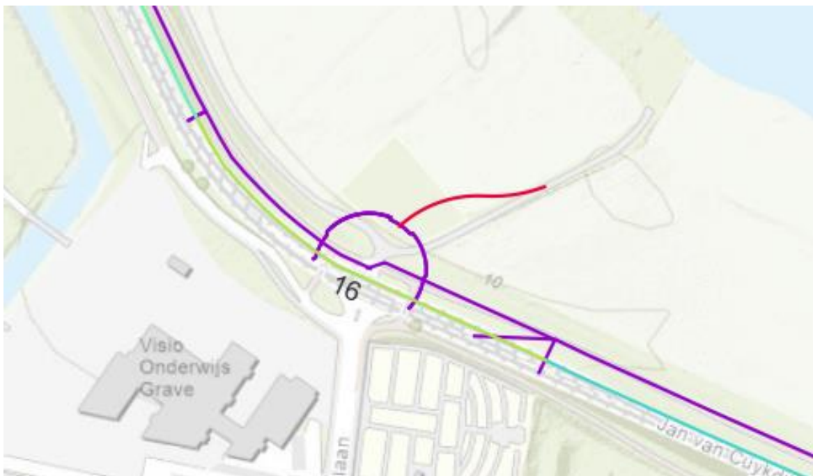
Figuur 3-1 Schematisering van de ronde in de N321 (paars, hoogwatervrije lijn) met de opritweg (rood, overlaat met een hoogte van NAP +10,5 m in de uiterwaard tot NAP +13,16 m bij de ronde)
