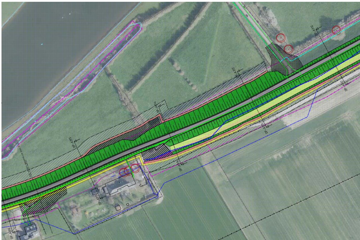
Figuur 6-23 Dijkvak 30 - Bovenaanzicht ontwerp oostelijk deel
