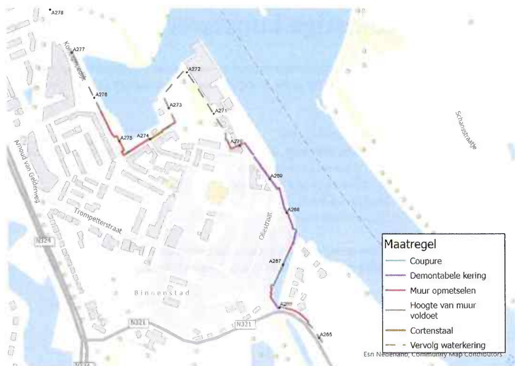
Figuur 5-1: Overzicht demontabele kering Grave.
