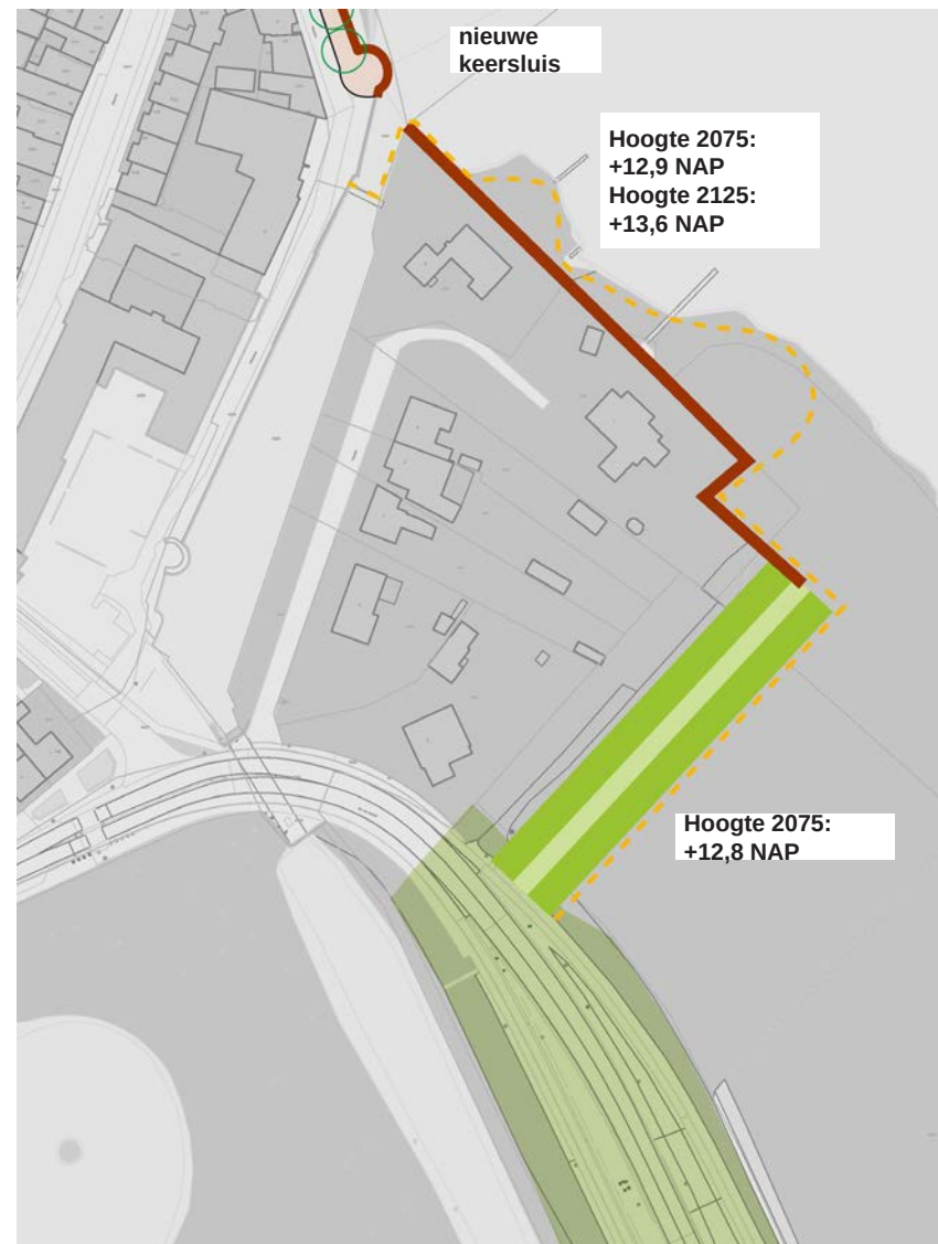
Figuur 5.23- Prinsenstal-Oude Haven: tracé Bomvrije (KA2)
