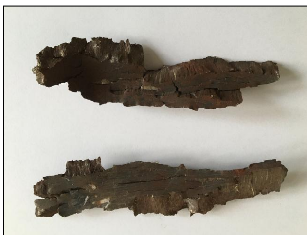
Afbeelding 49: Scherven na detonatie van een met springstof gevuld OO. (Bron: Bombs Away database).
