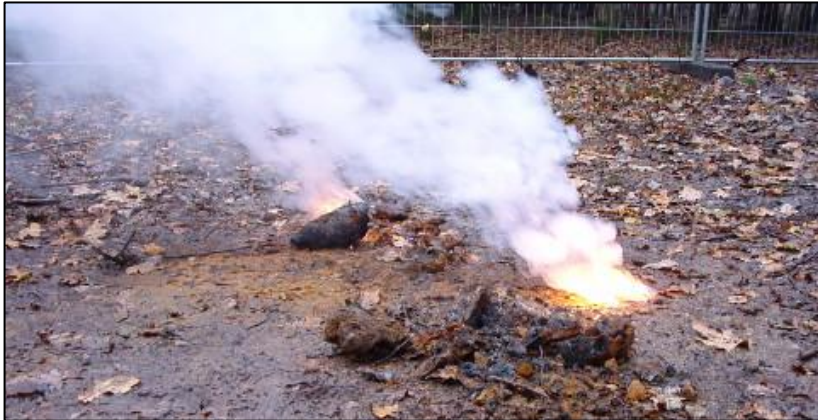
Afbeelding 50: Het opbranden van witte fosfor uit een opengebroken OO, gepaard gaande met veel rook. (Bron: Bombs Away database)
