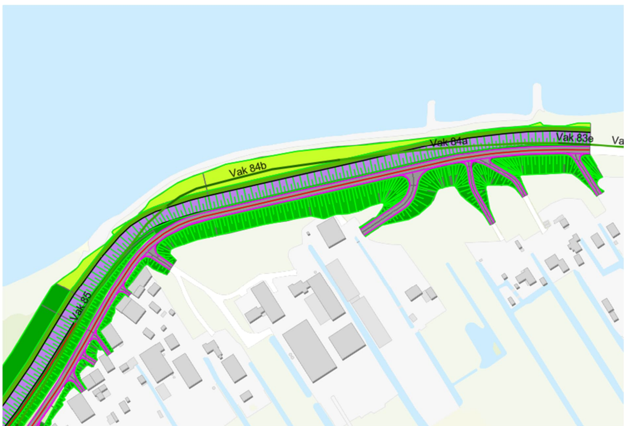
Figuur 10-4 Compensatie van verlies aan bergingsvolume door een binnenwaartse asverschuiving in dijkvak 84b.
