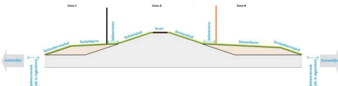
Figuur 3 zonering waterstaatswerk
