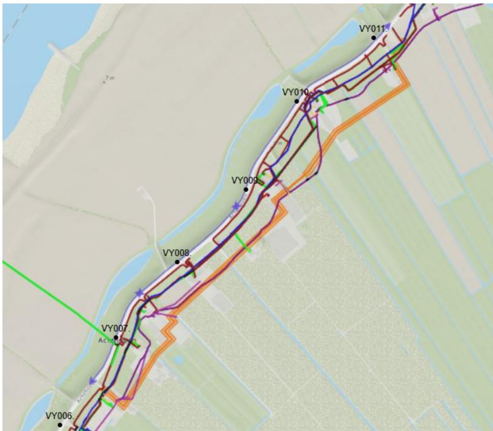
Figuur 3-3: Kabels en leidingen en verleglijn (oranje)
